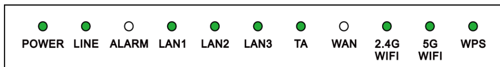
図 4-2 本製品が外部デバイスへの接続に成功した場合に点灯する LED
